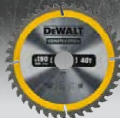
DT1945 PILOVÝ KOTOUČ CONSTRUCTION 190 x 30, 40 zubů, ATB 10°
