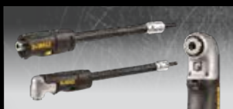
DT20502 PRAVOÚHLÝ ŠROUBOVACÍ NÁSTAVEC pro šroubování ve stísněných prostorech, magnetické přídržení šroubu, max moment 40 Nm. Pravoúhlý nástavec lze odpojit od flexibilního prodloužení.
